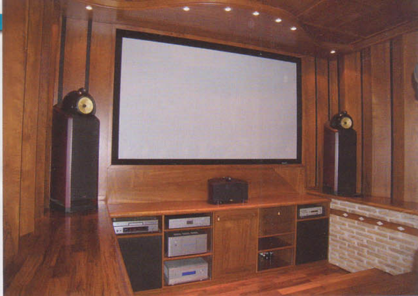
I diffusori principali si trovano ai due lati dello schermo, in posizione rialzata. Il canale centrale (qui in versione "non titolare") è poggiato proprio davanti agli ascoltatori.
